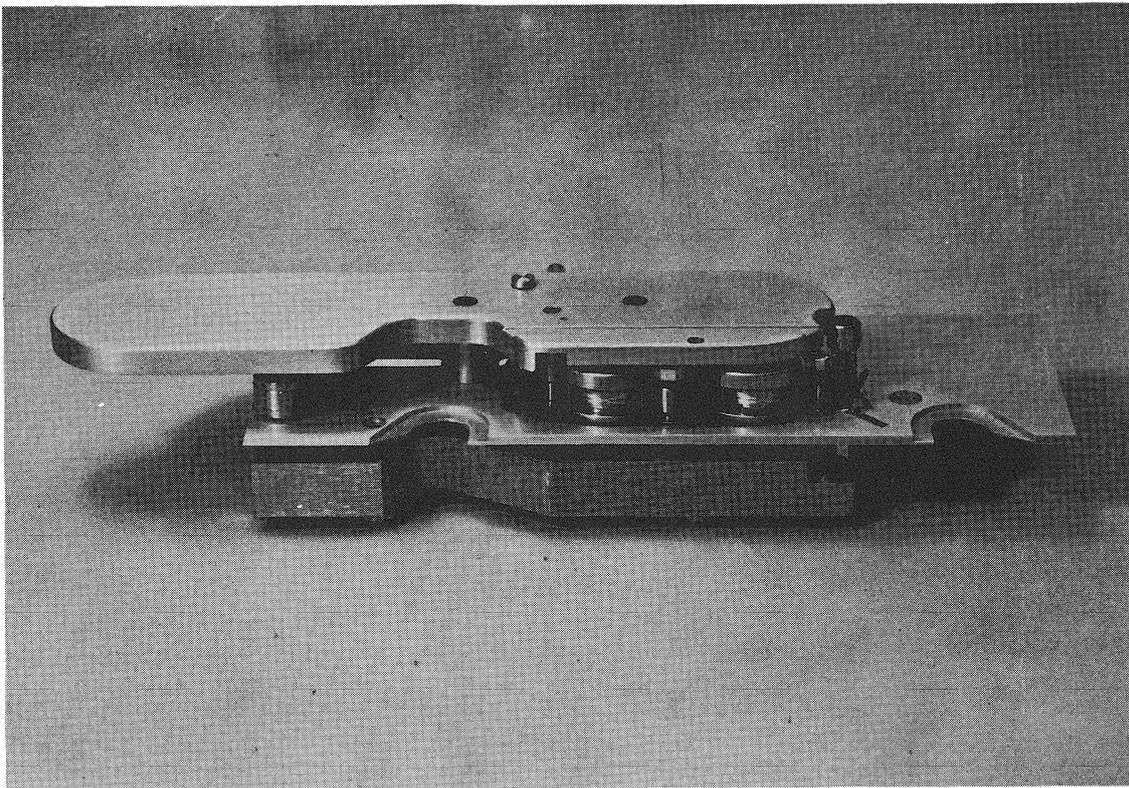
Durch die Verkleinerung der Distanz zwischen Aufnahme- und Wiedergabekopf musste die Beruhigungsrolle verkleinert werden. Verglichen mit dem bestehenden Kopfträgertyp werden alle Daten eingehalten.
